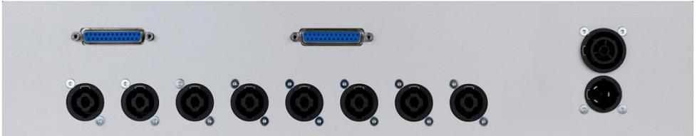
An der rechten Seite dieser Ansicht befindet sich die powerCON TRUE1 Buchse. Die untere Seite ist der Eingang. An der oberen Buchse kann man ein weiteres Gerät anschließen.
